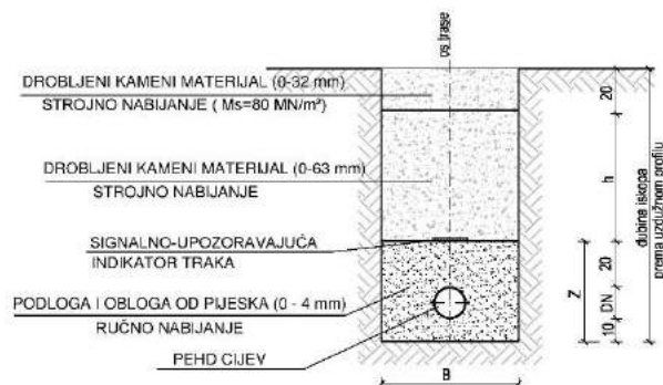
Slika 1.1.2.-3.: Prikaz poprečnih presjeka vodovodnog rova na različitim dionicama trase.
